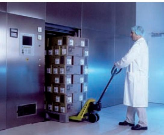
Abb. 1: Beladung eines EO-Sterilisators (geschlossenes System)
