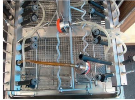
Abb. 4: Beladungswagen komplett mit Spülvorrichtungen ausgestattet und mit Druckloggern
