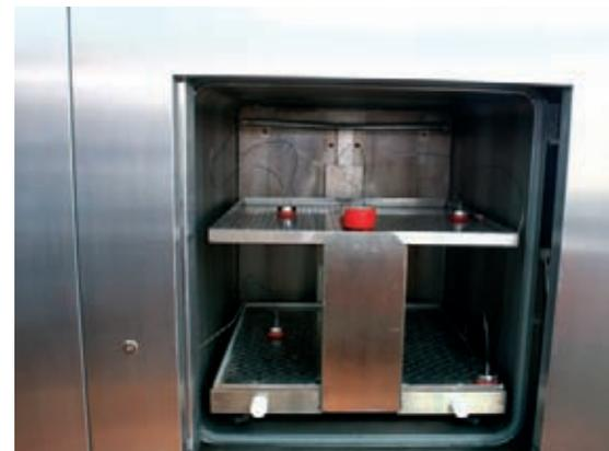
Abb. 1: Positionierung der drahtlosen Datenlogger
