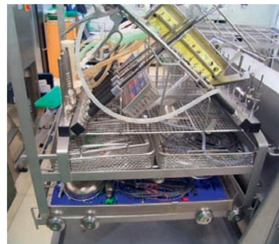
Abb. 2: unordentlich beladener Injektorwagen, z. B. Spülschatten durch Silikonmatte
