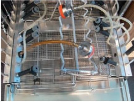
Abb. 3: Beladungswagen mit fehlender Silikonaufnahme rechts vorn und angeschlossenen Druckloggern
