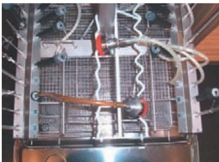
Abb. 6: Blindstopfen in benachbarten Positionen zu den Anschlüssen der Logger
