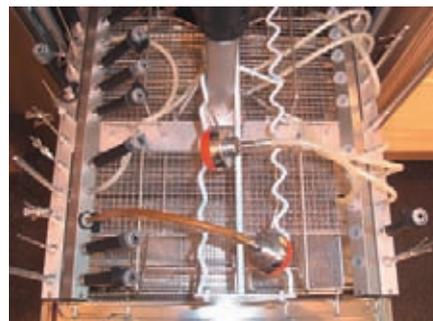
Abb. 7: rechte schräge Düsenreihe mit nicht belegten und nicht verschlossenen Silikon-aufnahmen
