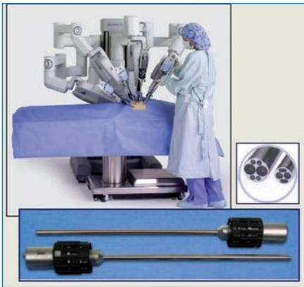
Abb. 7: Da Vinci OP-Roboter von Intuitive Surgical mit 3D-Optiken
