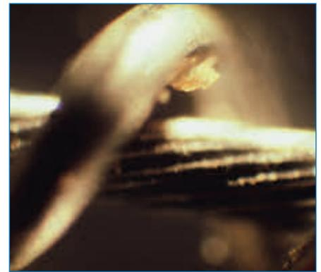
Abb. 1: Keimbelastete Proteinkoagel im Innenbereich einer Biopsiezange
