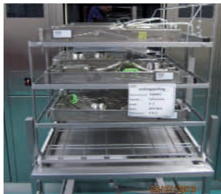
Abb. 1 und 2: Bei der Validierung geprüfte Referenzbeladungen mit offensichtlicher Unterbeladung gegenüber den tatsächlichen Routinebeladungen.
