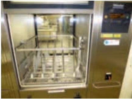
Abb. 4: Schlauchstücke als Prüfkörper im MIELE PG 8528 RDG
