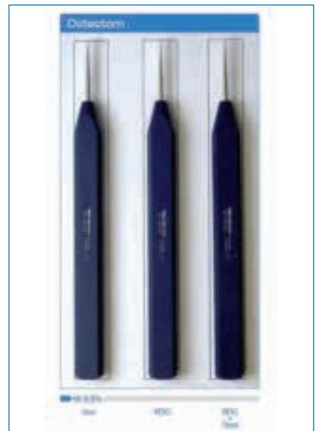
Abb. 9: Osteotom mit spezieller Oberflächenvergütung (von unten nach oben: neuer Zustand, nach 48 Zyklen Reinigung mit tX, nach 48 Zyklen Reinigung mit tX und Dampfsterilisation)
