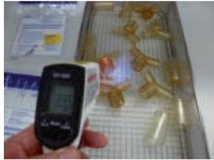
Abb. 5: Berührungsfreie Messung mit dem Infrarotthermometer: Schutz vor Rekontamination durch «non touch»
