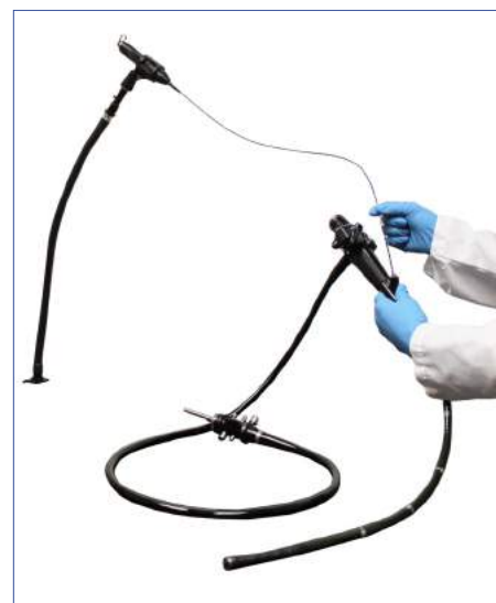
Fig. 6 Boroscopio de imagen para la inspección interna de canales de endoscopio.
