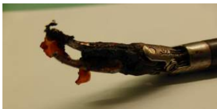
Fig. 2: Residuos encrustados en el extremo de un disector directamente después del uso Encrusted residues on the functional end of a dissector directly after use
