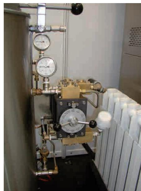
Fig. 2: Segundo prototipo de la generación de la autoclave instalado en un hospital comarcal en Eikwe, Ghana.
