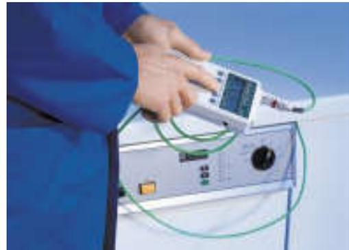
Abbildung 2: Messung RDT-Automaten
