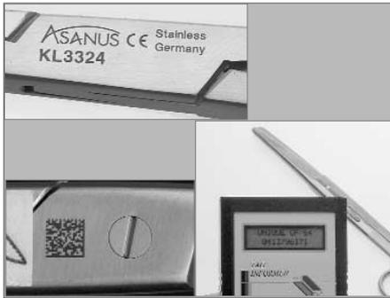
Abb. 4: Erfassung der Instrumente (Matrix-Code-Gravur)
