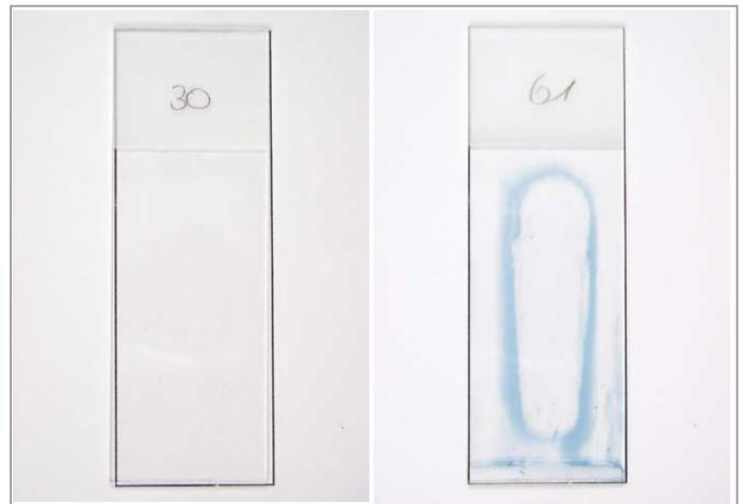
**Abb. 4:** Reinigungsergebnis mit 0,5 % alkalischem Reiniger in Hartwasser mit hoher Carbonathärte. Objektträger (30) nicht eingefärbt; Objektträger (61) eingefärbt
