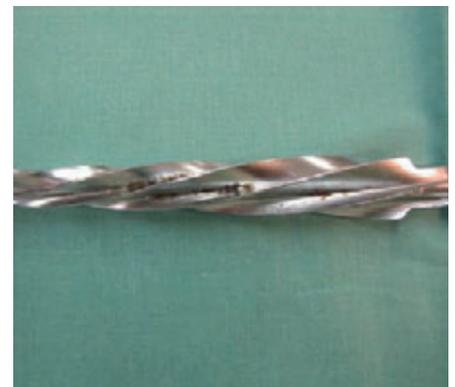
Abb. 1a/b: Typische Restkontamination nach ungenügender Aufbereitung
