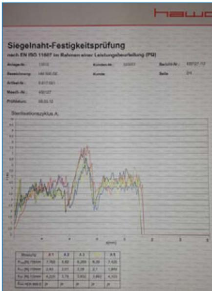
Abb. 1: Protokoll einer Siegelnahtfestigkeitsprüfung für die Leistungsbeurteilung
