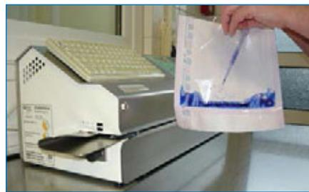
Abb. 2: Überprüfung der Qualitätseigenschaften mittels Tintentest (hier: Hawo InkTest)
