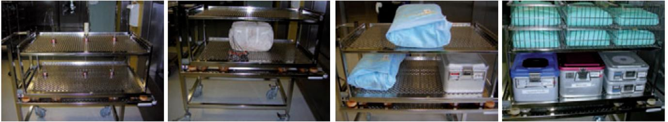
Abb. 3: Beispiele für Beladungen bei Sterilisationsprozessen (von li. nach re.): Leercharge, BD-Test Normprüfpaket, Teilbeladung, Vollbeladung
