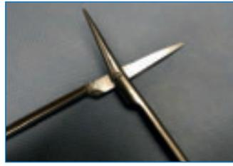
Abb. 2: Spannungsrisskorrosion
