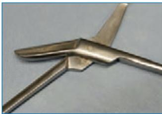
Abb. 5: Reibkorrosion
