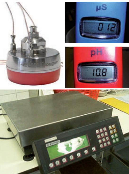
Abb. 1: Messausrüstung, Beispiele: Datenlogger, Leitwertmessgerät, pH-Wert-Messgerät, Waage
