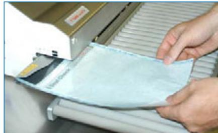
Abb. 3: Überprüfung der Siegelnaht mittels Siegelindikator (hier: Hawo Seal Check)
