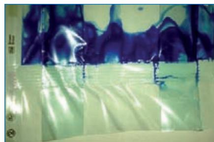
Abb. 2: Kanäle oder Fehlstellen können durch die Tinte lokalisiert werden (hier: Seitenfaltenfolie, Test mit hawo InkTest)
