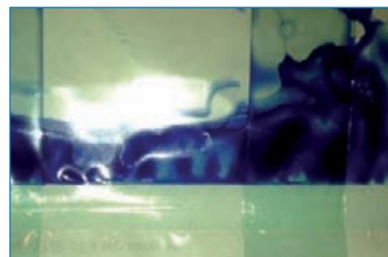
Abb. 3: Fehlerfreie Siegelnaht (hier: Seitenfaltenfolie versiegelt mit hawo Siegelgerät, Test mit hawo InkTest)
