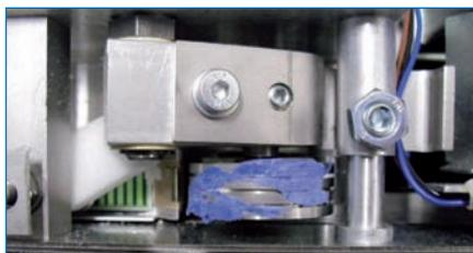
Abb. 3: Verunreinigte Anpressrolle
