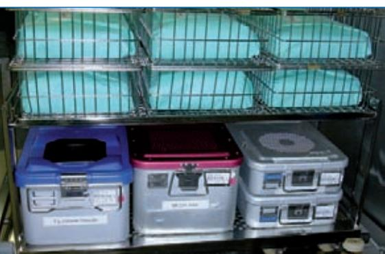
Abb. 6: Restfeuchte und mögliche Beschädigungen sind rundum nur beim Korb/Sieb-system beurteilbar
