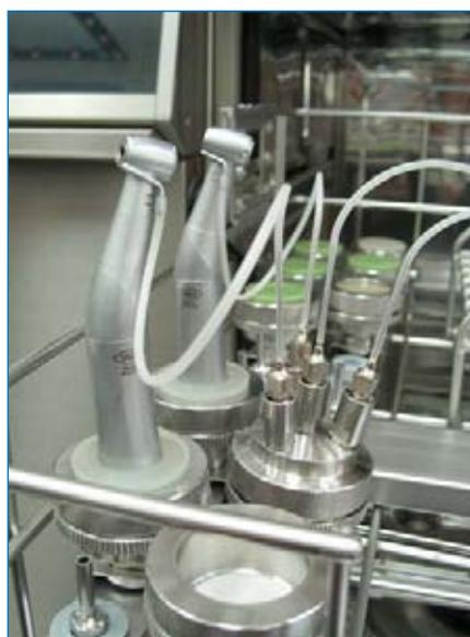
Reinigung muss „ankommen“ – hier an einem zahnärztlichen Handstück, dessen Kanäle mittels Durchspülung von Rückständen befreit werden müssen
