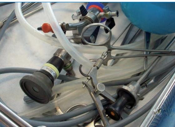
Abb. 1: Nicht gesicherte, nicht ordnungsgemäß abgelegte Optiken (eine steckt im Arbeitskanal, eine kann beschädigt werden)
