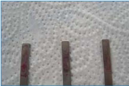
Abb. 1: Anfärbung, von links nach rechts zu 20, 10 und 5 µg Protein pro cm<sup>2</sup>
