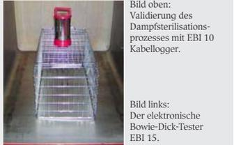
Bild oben: Validierung des Dampfsterilisationsprozesses mit EBI 10 Kabellöser.
