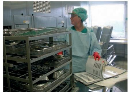
Abb.10: Bestückung eines Reinigungs-Desinfektionsgerätes ist manuell und erfordert Erfahrung
