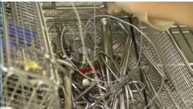
Mit den 1,2 mm dünnen Kabelfühlern wird in Endoskopen oder Kapillaren die Desinfektions- oder Sterilisationstemperatur mit 0,1 °C Genauigkeit festgestellt.
