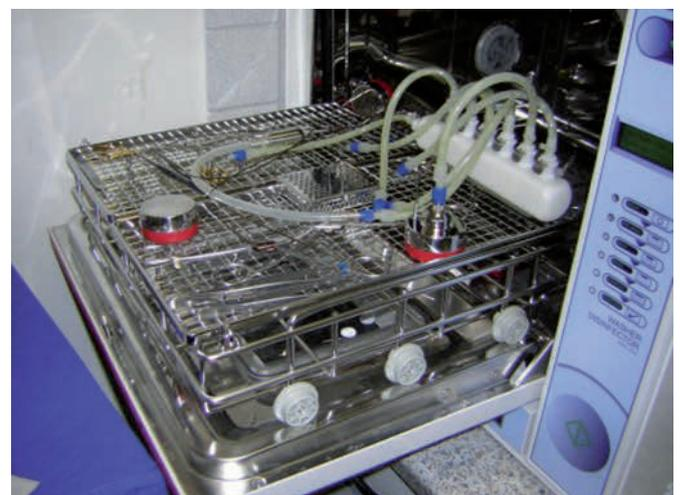
Abb. 4: Komplett Spülversorgung durch vollständige Konnektion, Kontrolle der Parameter durch Datenlogger
