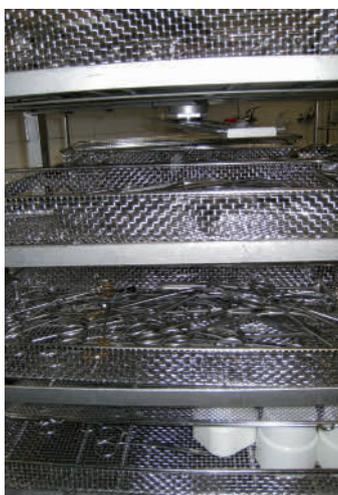
Abb. 2: Freie Zugänglichkeit der Siebkörbe, freilaufender Sprüharm
