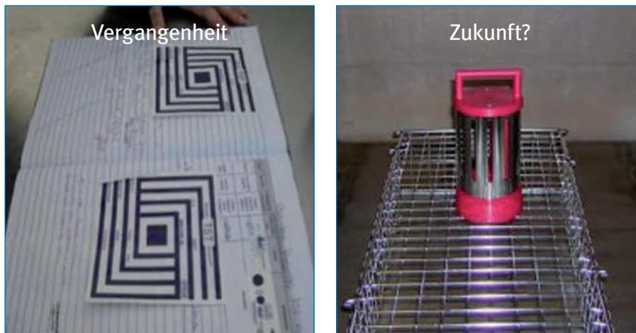
Abb. 1: Der klassische Bowie-Dicktest (links) und die elektronische Datenlogger-Simulation (rechts) mit Verlaufskontrolle (statt Farbumschlag zum Zeitpunkt X und unnötigem Aufheben der verfärbten BD-Indikatoren)
