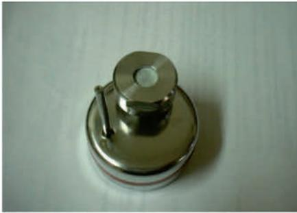
Abb. 1: Drucklogger mit offener Membran
