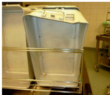
Abb. 8 und 9: Transportprobleme bei Aufzugverwendung: die unbedachte Beladung des Transportwagens führt zu Container-Beschädigung an der Aufzugtür.
