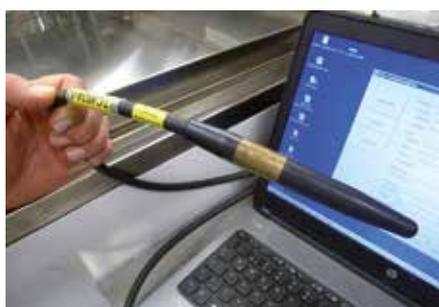
Abb. 3: Hydrophon zur Ultraschall-Leistungsmessung
