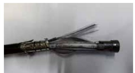
Abb. 1 – 3: Anlieferung der Proben, Identifizierung der Probennahmeorte, zerstörter Arbeitskanal
