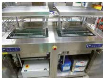
– Bei ZSVA-Neubauten sollte zusätzlich noch rückseitig eine kontinuierliche Luftabsaugung installiert werden, da so beim Öffnen des Deckels Ausdünstungen und Wrasen abgesaugt werden.
