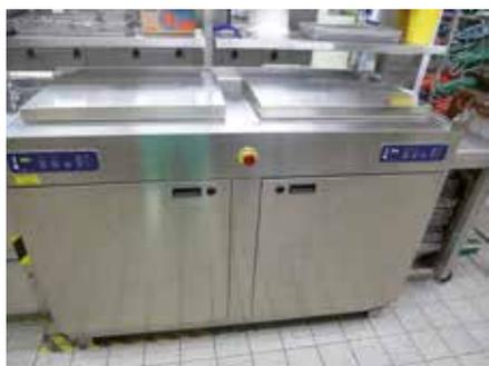
Abb. 2 US-Gerät Fa. STEELCO 2 x 60 l Ultraschallreinigungsgerät; Kapazität bis zu 4 Siebe/12LL-Anschlüsse pro Gerät. Links: geschlossen; Rechts: hochgefahrte Deckel mit Hebevorrichtung, Sonochemie Konzentrat blauer Behälter neodisher SeptoMed®
