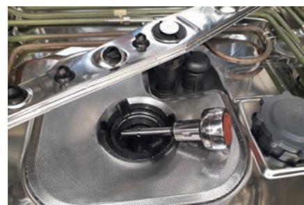
Abb. 2: Leitwertlogger im Ablauf der RDG zur permanenten Messung
