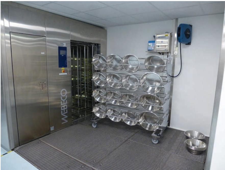
Abb. 13: Containerwaschanlage (CWA) für je 64 Waschschüsseln pro Charge. Programmdauer ca. 35 Minuten,  $A_0$ -Wert hier  $> 3250$ ; Auch für die Aufbereitung von Sterilgutcontainern, Entsorgungscontainern, Transportwagen, OP-Schuhen, auch chirurgische Instrumente außer MIC-, Lumen-, und Anästhesie-MP geeignet.
