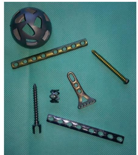
Abb. 1: Titan-Implantate 3D-Druck
