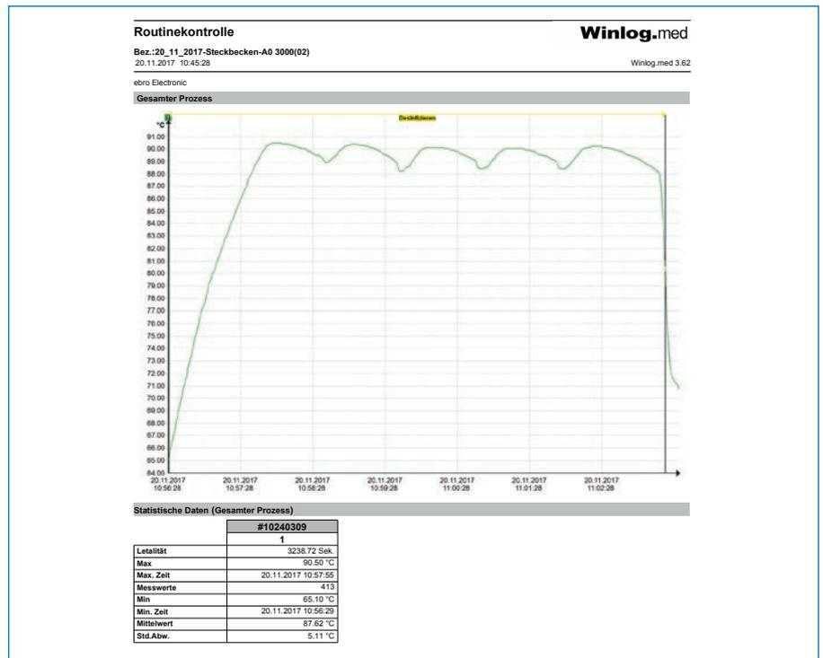
Abb. 10: Messung  $A_0$ -Wert 3000 mit ebro Thermologger
