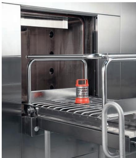
**Abb. 1:** Der Datenlogger EBI 16 (elektronischer Bowie&Dick-Test) bildet zusammen mit der Auswertesoftware Winlog.med ein technisch versiertes und zuverlässiges Messsystem.
