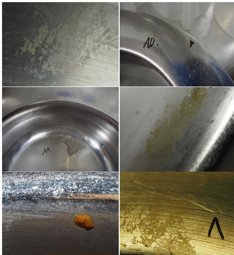
Abb. 5: Stuhlreste nach typischer Aufbereitung im Steckbecken-RDG
