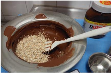
Abb. 1: Aufbringen der Prüfsubstanz auf CrNi-Stahl Steckbecken
