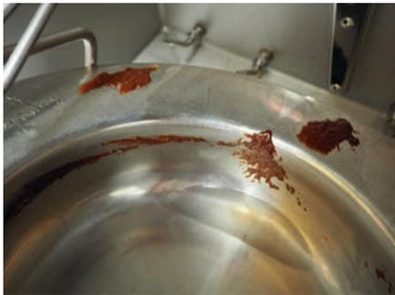
Abb. 2: Reste der Prüfschmutzung nach Standardprogramm im Steckbeckenspülgerät
