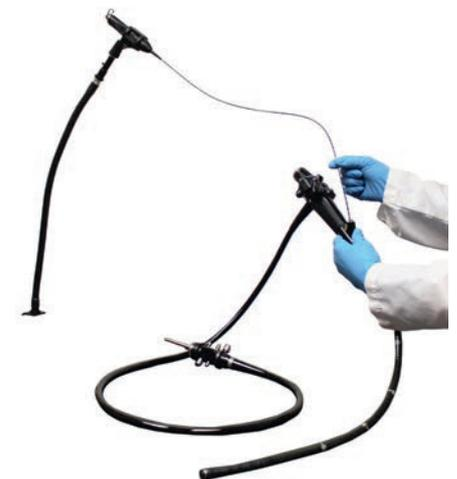
Abb. 6: Video-Endoskop für die innere Betrachtung von Endoskopkanälen
