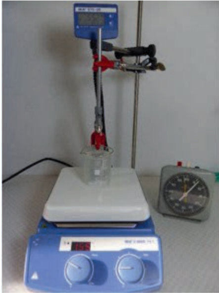
Fig. 1: Dispositivo de prueba para comprobar el efecto de la limpieza
