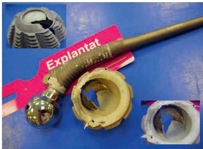
Abb. 1: Hüftkopf (Kunststoff-Inlay) komplett und das Pfannendach (Titan?) erheblich zerrieben. Der Patient stand kurz vor dem «Durchbruch» durch die noch «vorhandene Hüftpfanne» (Prothesenpfanne wie Acetabulum).
