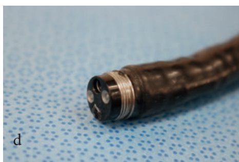
Fig. 1: c) A simple vista, esta punta de endoscopio tiene buen aspecto. c) A simple view, this endoscope tip appears in good shape. d) Con el aumento se ve enseguida que el tubo de inserción está dañado. d) Under magnification, damage to the insertion tube is easily identified.
