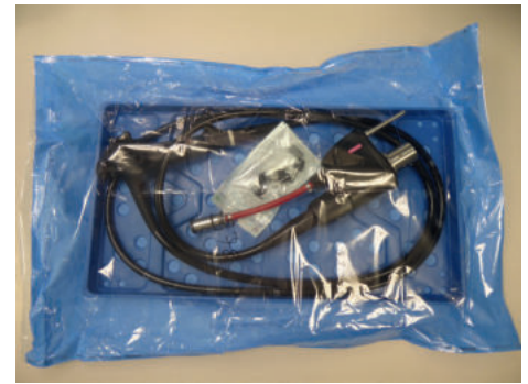
Fig. 2: Ejemplo de acondicionamiento: gastro-duodenoscopio R. PENTAX, con doble acondicionamiento en papel/lámina. La fotografía muestra el envase de prueba para el examen microbiológico. Canales cerrados con cepas esporuladoras ( Geobacillus stearothermophilus ).
