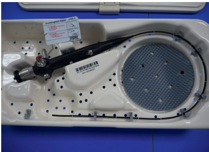
Fig. 1: Videobroncoscopio moderno para adultos con tapón de compensación de presión. Para la esterilización VBTF se procede a un doble acondicionamiento (papel/lámina) del envase.
