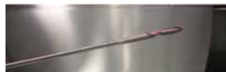
Fig. 1: El taladro flexible de médula ósea puede y debe doblarse para cepillarse y enjuagarse internamente
