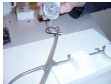
Fig. 1: Equipamento e medição da força necessária para abrir um grampo a um determinado ângulo
