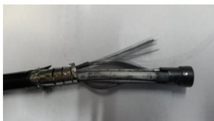
Abb. 1-3: Anlieferung der Proben, Lokalisierung der Entnahmeorte, zerstörter Arbeitskanal.
