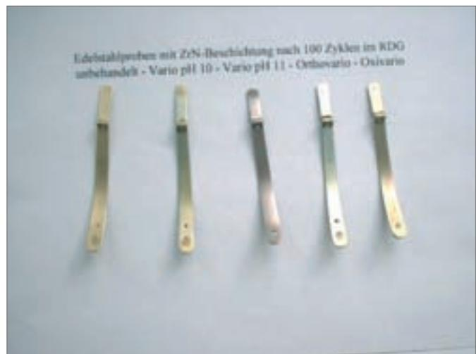
**Fig. 2 :** Décolorations du revêtement à l'azoture de zirconium (ZrN) après 100 cycles de différents processus de nettoyage
