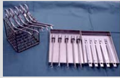
Fig. 7: Instrumentos para las mediciones de la recuperación del contaminante test - las placas de metal eran secado en seguida
