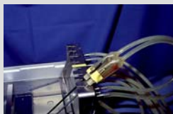
Fig. 3: Elución de instrumentos tubulares (de proximal a distal) de la sala de operación - el color rojo indicata sangre human
