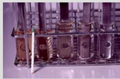
Fig. 5: Concentraciones (y colores) diferentes de sangre sobre placas de metal - mediciones para los rangos de recuperación
