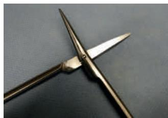
Fig. 2: Corrosión por tensofisuración / Corrosion sur fissure de tension
