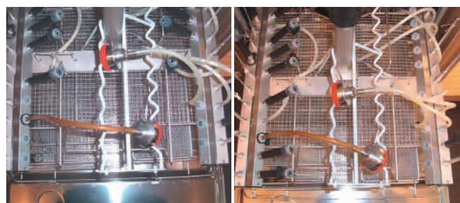
Fig. 6: Tapones ciegos en posiciones adyacentes a las conexiones del registrador / Vis d'obturation sur les emplacements voisins des raccords de l'enregistreur
