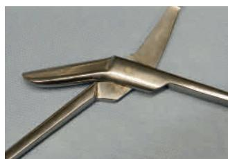
Fig. 5: Corrosión por contacto / Corrosion de friction
