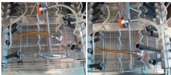
Fig. 3: Carro de carga con tomas de silicona que faltan, delante a la derecha, y registradores de presión / Support de charge avec fixation avant droit en silicone manquante et enregistreur de pression fixé
