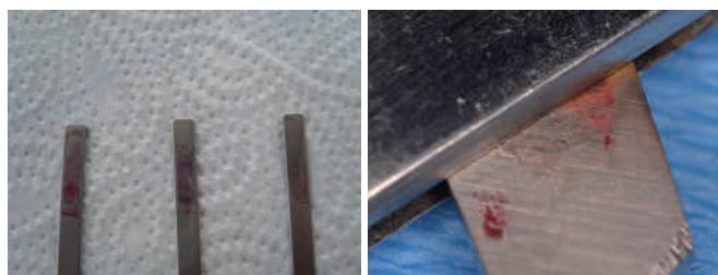
**Fig 1:** Coloración, de izquierda a **Fig. 2:** Detección de la proteína derecha 20, 10 y 5 µg de proteína por coloración en el área de la articulación / Coloration, de gauche à articulation / Détection de protéine droite, 20, 10 et 5 µg de protéines nes par une coloration de la zone articulée
