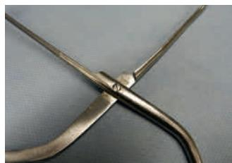
Fig. 4: Corrosión por picaduras / Corrosion occasionnant des perforations
