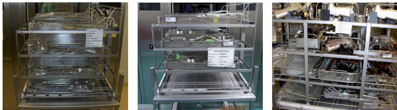
Fig. 1 y / et 2: Durante la validación de las cargas de referencia probadas con subcargas aparentes en comparación con las cargas rutinarias reales / Charges de référence visiblement incomplètes pour la validation par rapport aux charges en exploitation réelle
